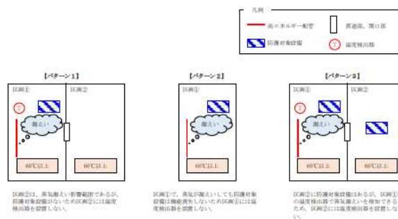
図2 区画配置温度検出器設置概念図
