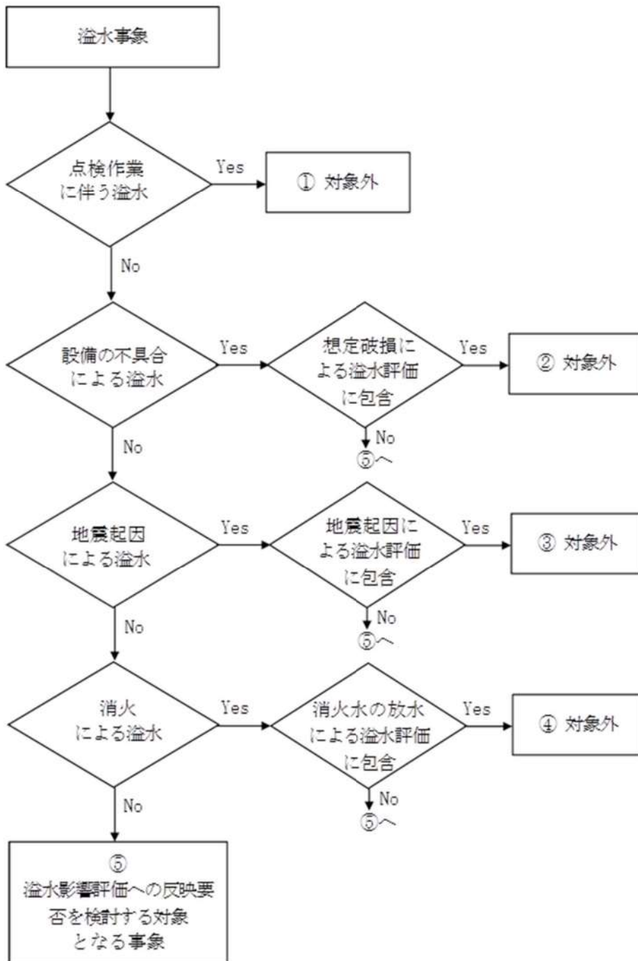
図1 内部溢水影響評価への反映要否判断フロー
