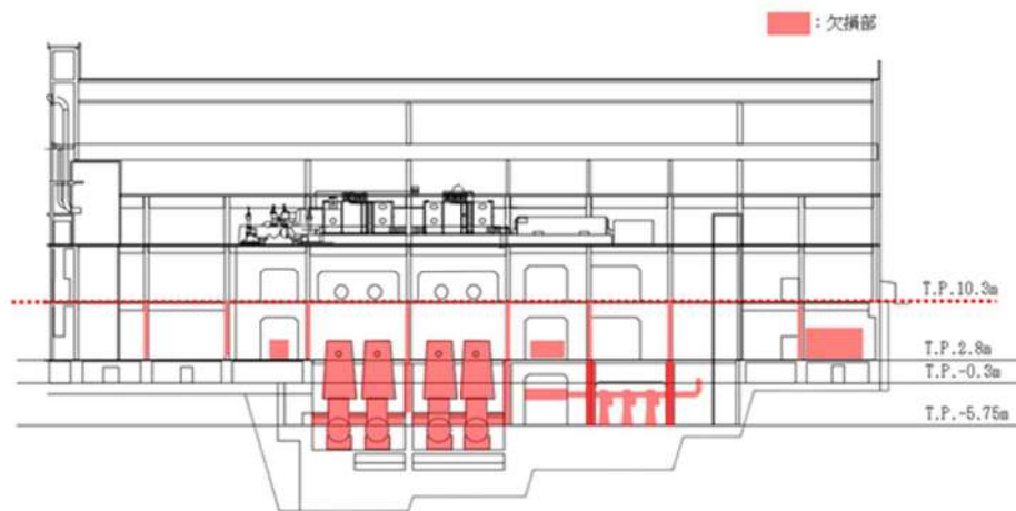
図2 タービン建屋断面図
