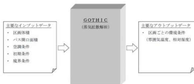
図1 GOTHIC コードのインプット、アウトプットデータ
