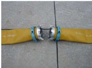
可搬型ホース (150A) 接続口
