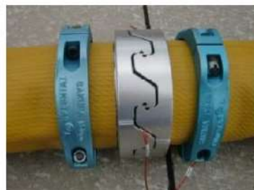
可搬型ホース(150A)接続後
