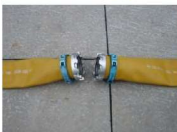
可搬型ホース(150A)接続口
