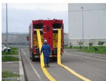
ホース延長・回収車(送水車)による 可搬型ホース敷設 (屋外 T. P. 10. 3m)
