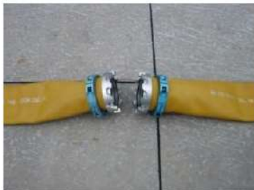
可搬型ホース (150A) 接続口
