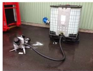
小型放水砲及び泡消火薬剤
