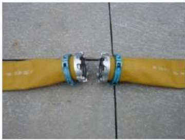
可搬型ホース (150A) 接続口
