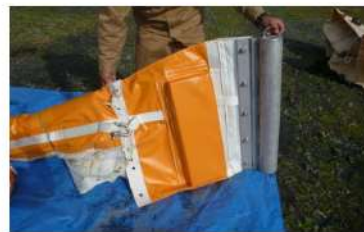
荷揚場シルトフェンス端部
