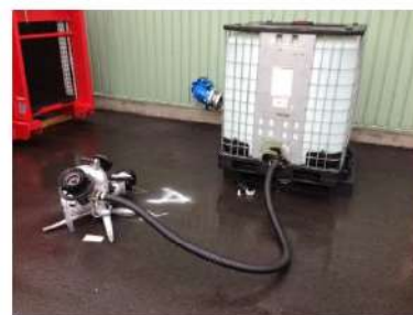
小型放水砲及び泡消火薬剤
