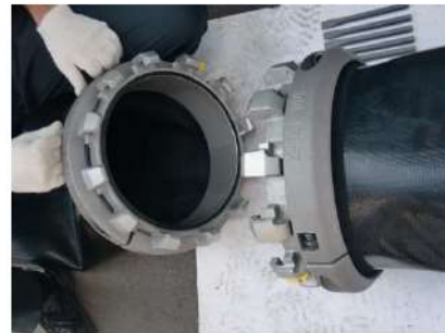
可搬型ホース(300A)接続口
