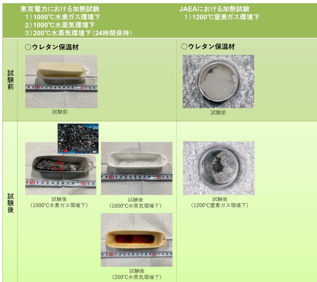
図11 東京電力及びJAEAにおける加熱試験（ウレタン保温材の例）
