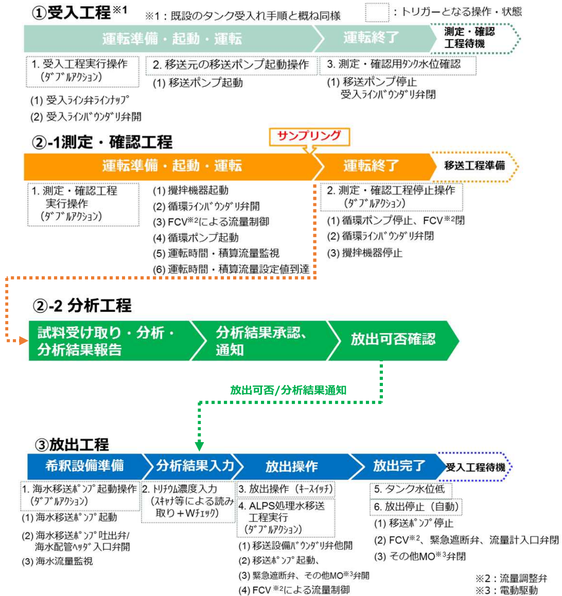
図-3 受入，測定・確認，放出工程の手順
