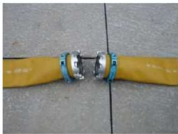
可搬型ホース (150A) 接続前
