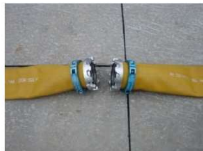
【図2 可搬型ホース接続】
