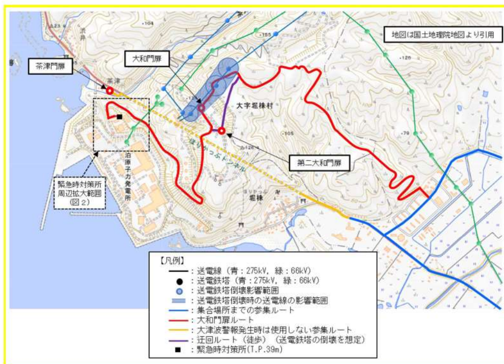
図1 発電所周辺の参集ルートと送電鉄塔の位置
