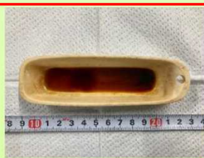
試験後 (200°C水蒸気環境下)
