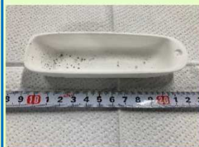
試験後 (1000°C水蒸気環境下)
