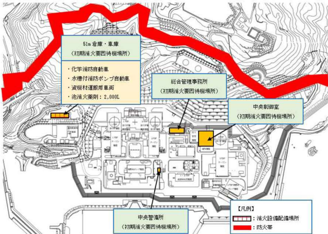
第 1-16 図：移動式消火設備の配置の概要
