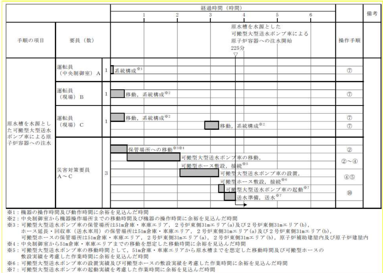
第 1.4.15 図 原水槽を水源とした可搬型大型送水ポンプ車による 原子炉容器への注水 タイムチャート
