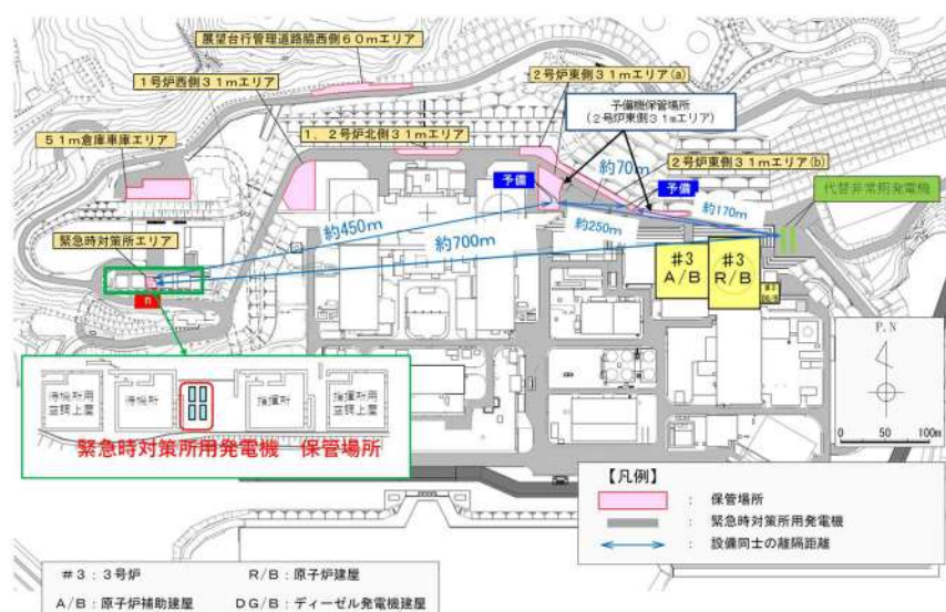
図4-10 緊急時対策所用発電機の保管場所
