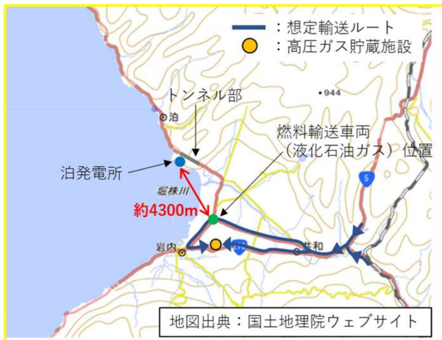
図 4-7 高圧ガス輸送車両爆発想定位置と発電用原子炉施設との位置関係
