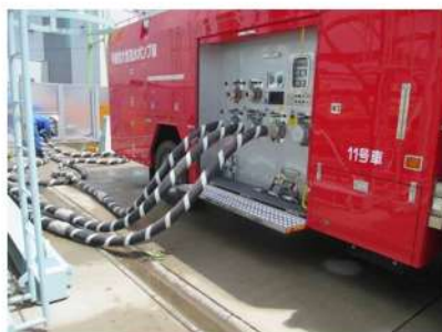
【図1 可搬型大型送水ポンプ車】
