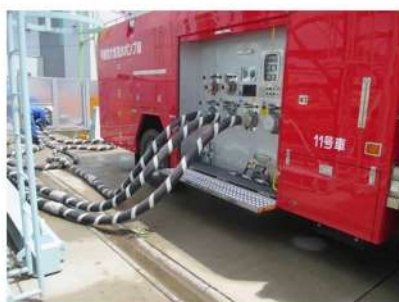
【図1 可搬型大型送水ポンプ車】
