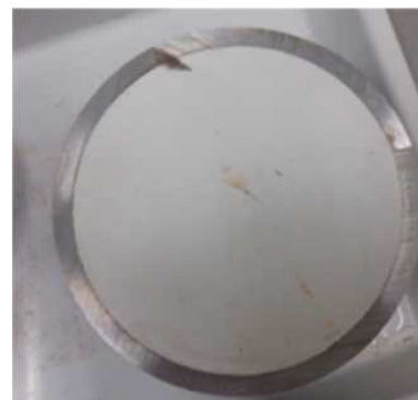
(3) プレス後に切断した鉄製型枠 (4) 固化体(677g)の一部(切断面, Φ123mm)
