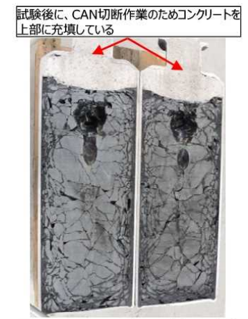
図3 実規模試験で作製された固化体 (炭酸塩スラリー、鉄共沈スラリー)
