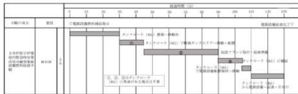
参考図 8.1-2 5号炉原子炉建屋内緊急時対策用可搬型電源設備
