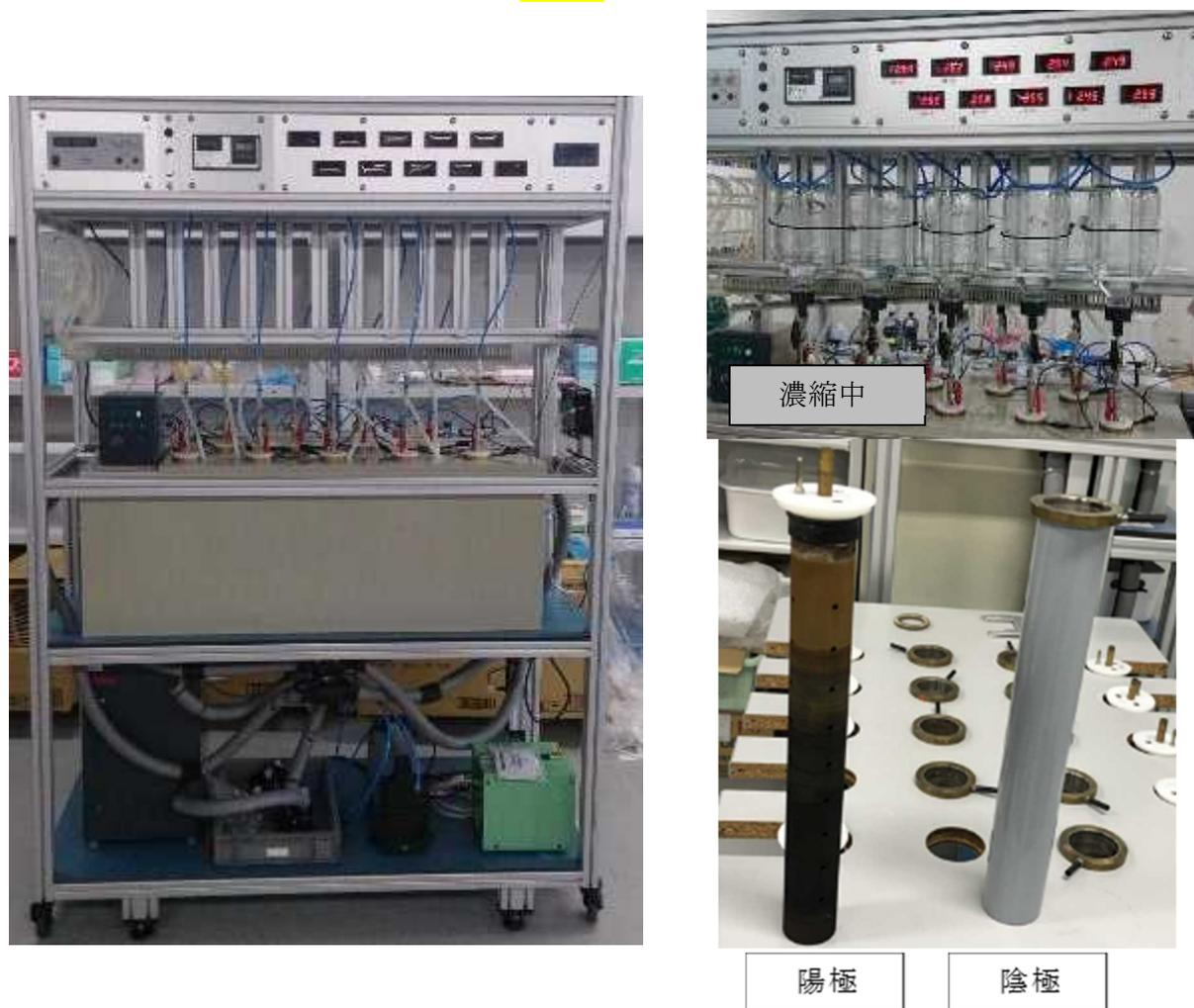
図 A.2 装置と電極の外観
