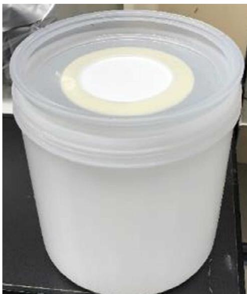
図3.10 パッシブ法の捕集容器の例
