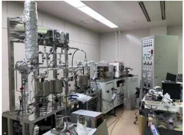
参図 D. 3 希ガス質量分析計
