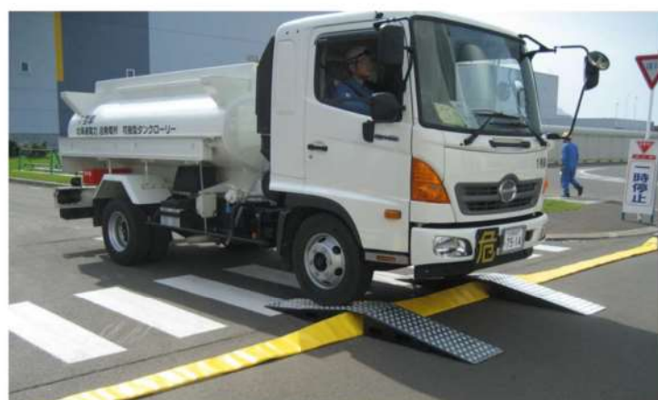
第1図 ホースブリッジの設置状況
