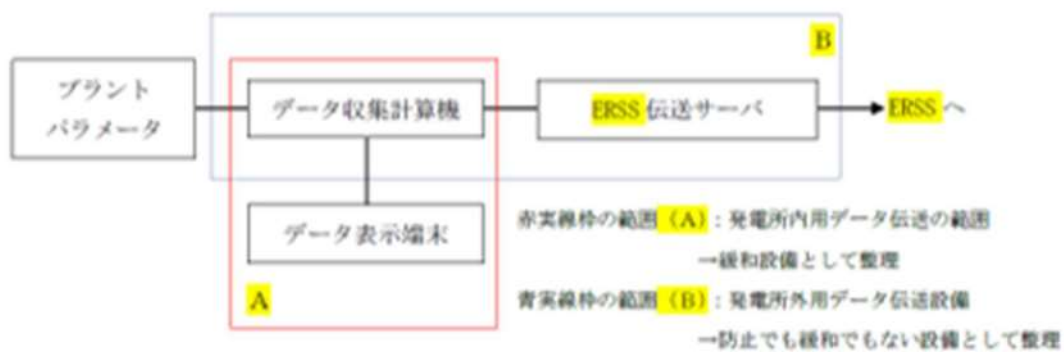
図5.4-2 緊急時対策所情報収集設備の概要
