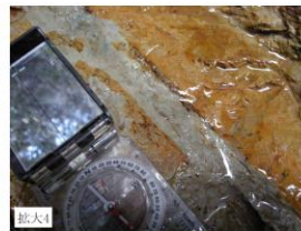
泥岩中の断層面の連続性はやや不明瞭で平面性は低い。また幅約5mmの砂礫岩を挟在しているが、粘土状破砕部を伴わない。 砂礫岩は、周囲の砂岩層と同様の固結の程度である。
