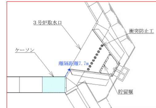
南防波堤基部と3号炉取水口の離隔距離
