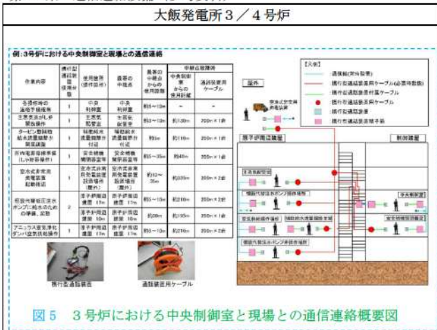
参考第3.1-1図 携行型通話装置を用いた通信連絡の概要
