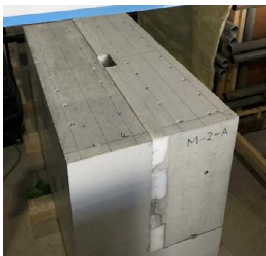
手順4：注入箇所除去
