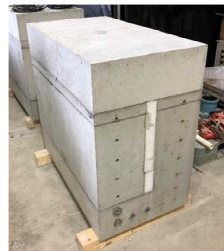
手順6：上部設置（試験体完成）
