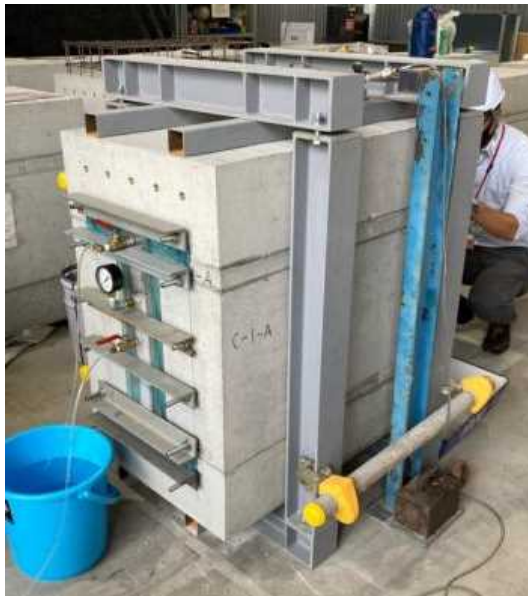
写真1. 試験体（加圧側）
