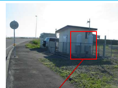
電離箱検出器及びNaI(Tl)シンチレーション検出器。防潮堤との距離は防潮堤に近い検出器で代表している。
