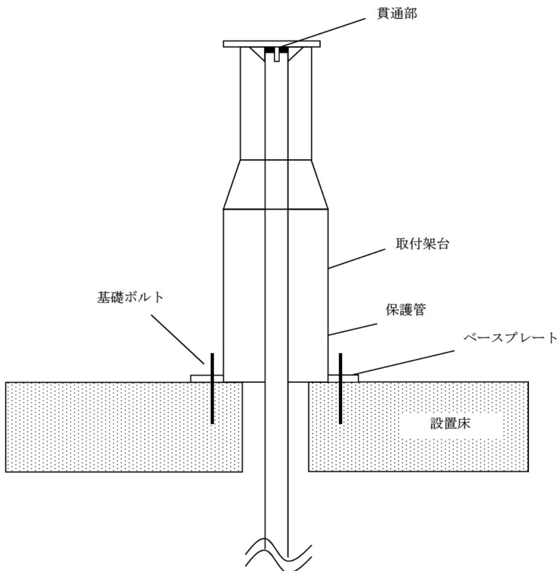
図 取付架台の構造及び設置状態
