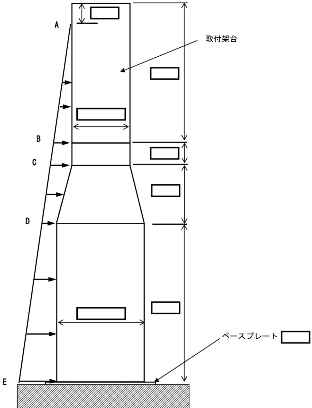
図 取付架台に作用する津波荷重のイメージ
