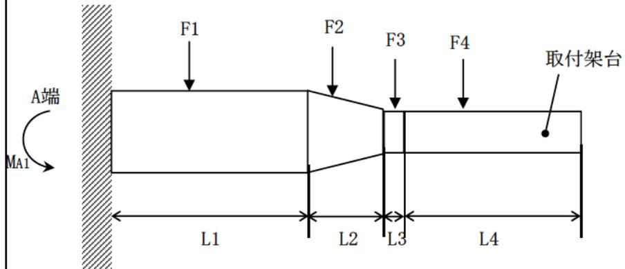
図2-2 津波波力による計算モデル
