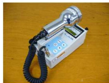
(GM 汚染サーベimeter)
