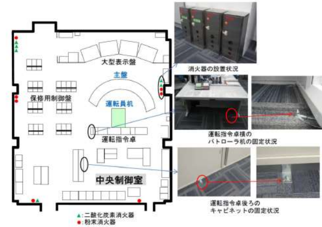
図 2.4.2 中央制御室における消火器の設置状況及びキャビネット等の固定状況
