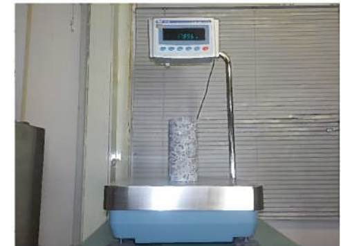
遮蔽能力の点検状況 (乾燥単位容積質量の測定状況)
