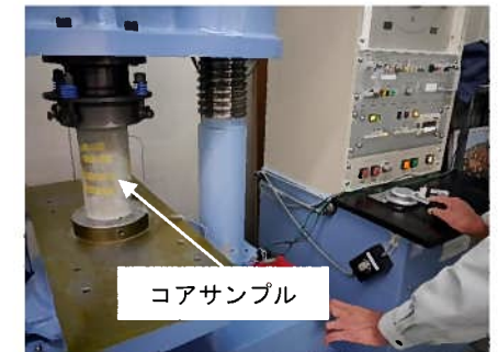
強度の点検状況
