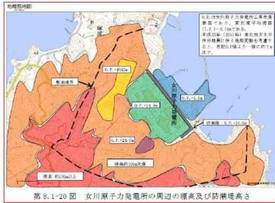
第8.1-20図 女川原子力発電所の周辺の標高及び防備堤高さ
