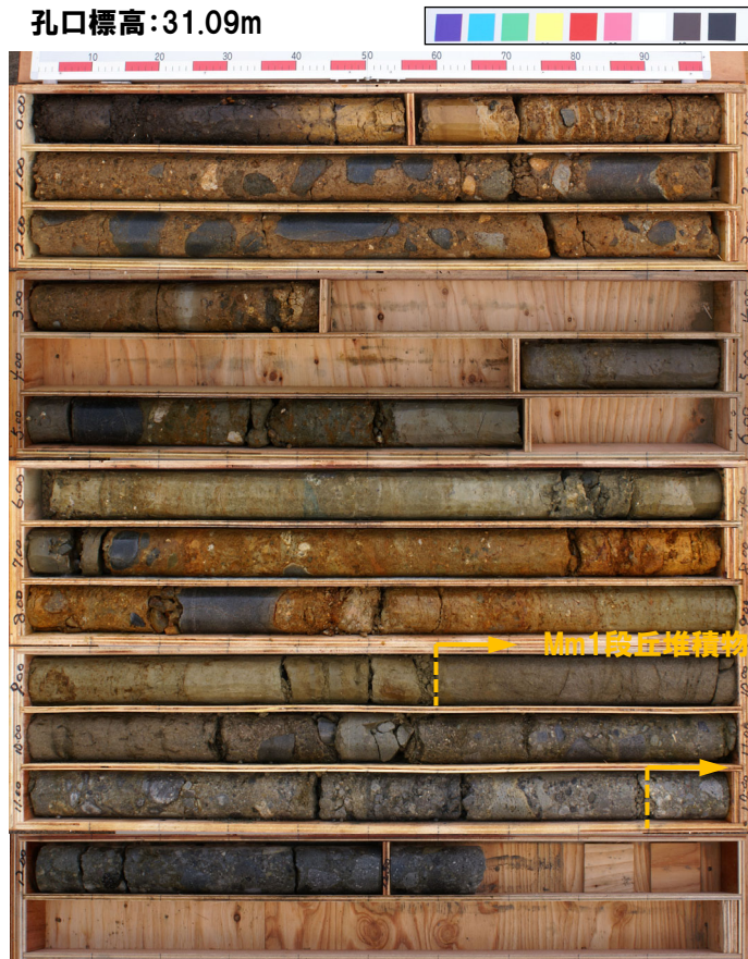
コア写真(深度0~12.5m) (2010年4月撮影)
