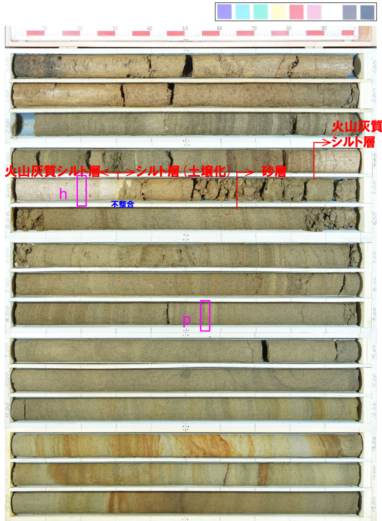
□:火山灰分析試料主要採取位置 コア写真 (深度0~15m, 標高34.87~19.87m)
