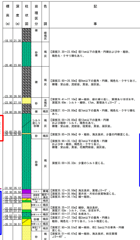
ボーリング柱状図(深度20~40m)
