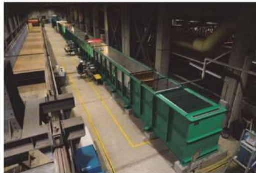
図** 水理模型実験 対象断面
