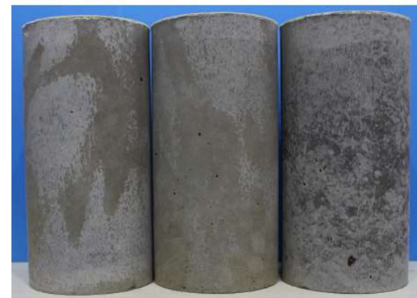
セメント改良土の室内試験用供試体(φ150mm, H300mm)
