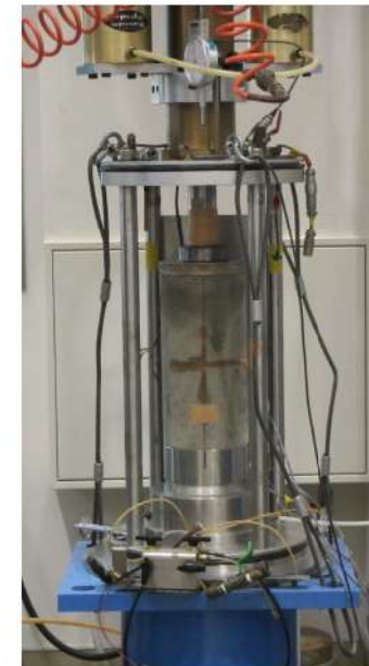
一軸圧縮試験の状況
