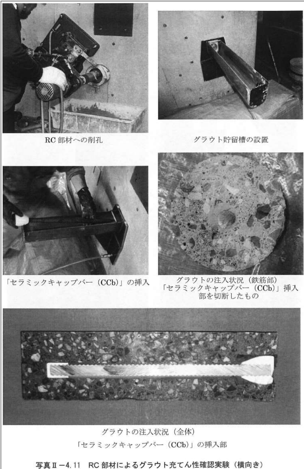
第 4.6-3 図 グラウトの充てん性確認実験 (建設技術審査証明報告書より抜粋) (4/10)
