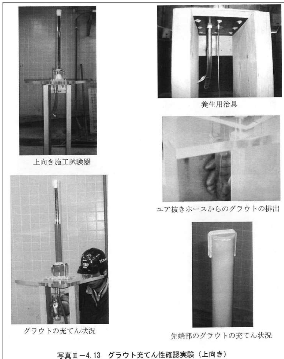
第 4.6-3 図 グラウトの充てん性確認実験 （建設技術審査証明報告書より抜粋）（10/10）
