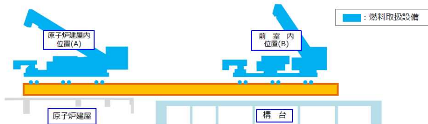
図 4.2.1-1 燃料取扱設備の位置
