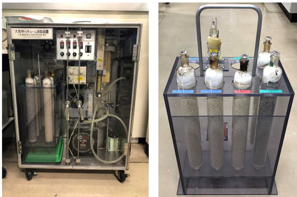
図 3.1 モレキュラーシーブを用いた採取装置例
