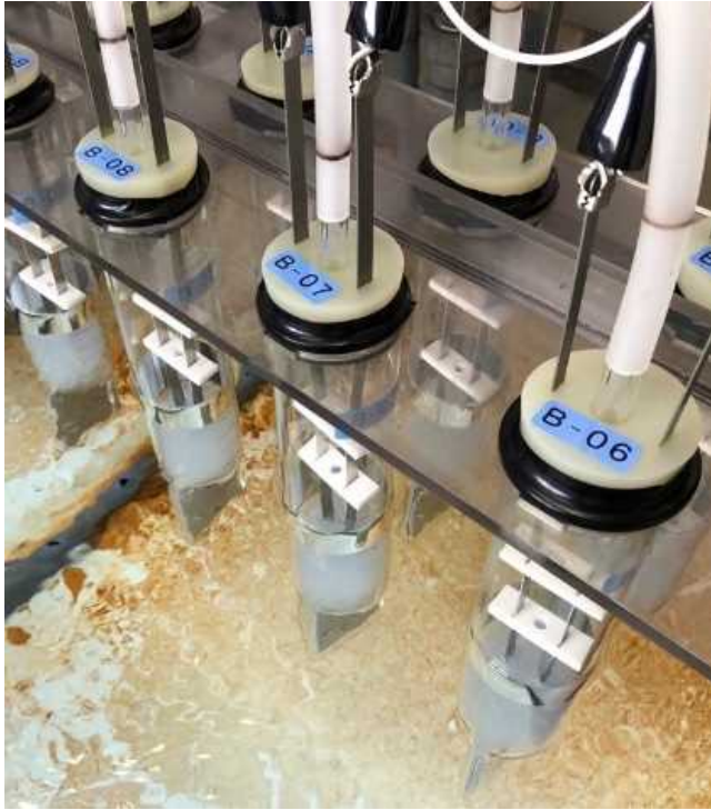
図 2.6 電極を用いた電解濃縮の様子
