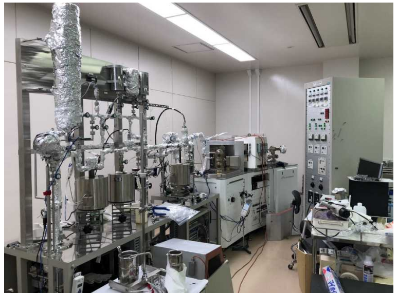
図 C.2 生物試料を封入した密閉容器 図 C.3 希ガス質量分析計 (手前がガス精製ライン、奥が質量分析計)
