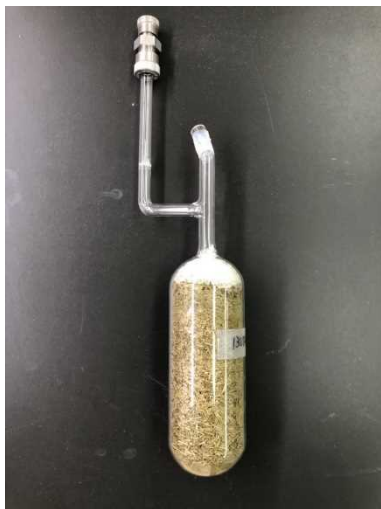
図 C.2 生物試料を封入した密閉容器 図 C.3 希ガス質量分析計 (手前がガス精製ライン、奥が質量分析計)
