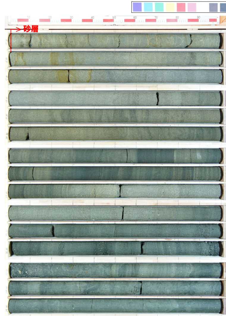
H29岩内-5コア写真 (深度15~30m, 標高8.24~-6.76m)
