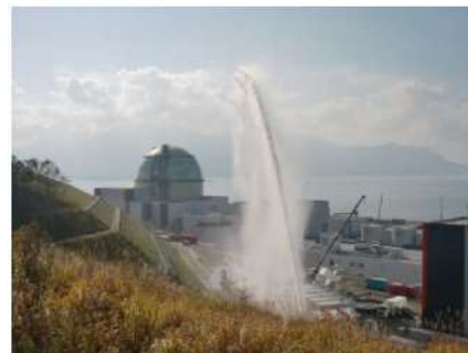
図7-10 直状放射による放水状況
