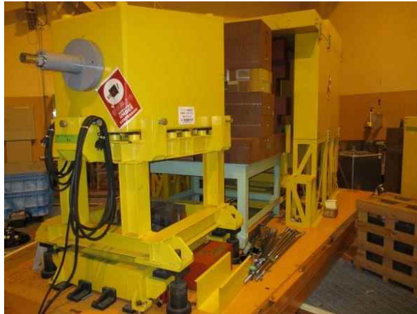
検出器回転架台
