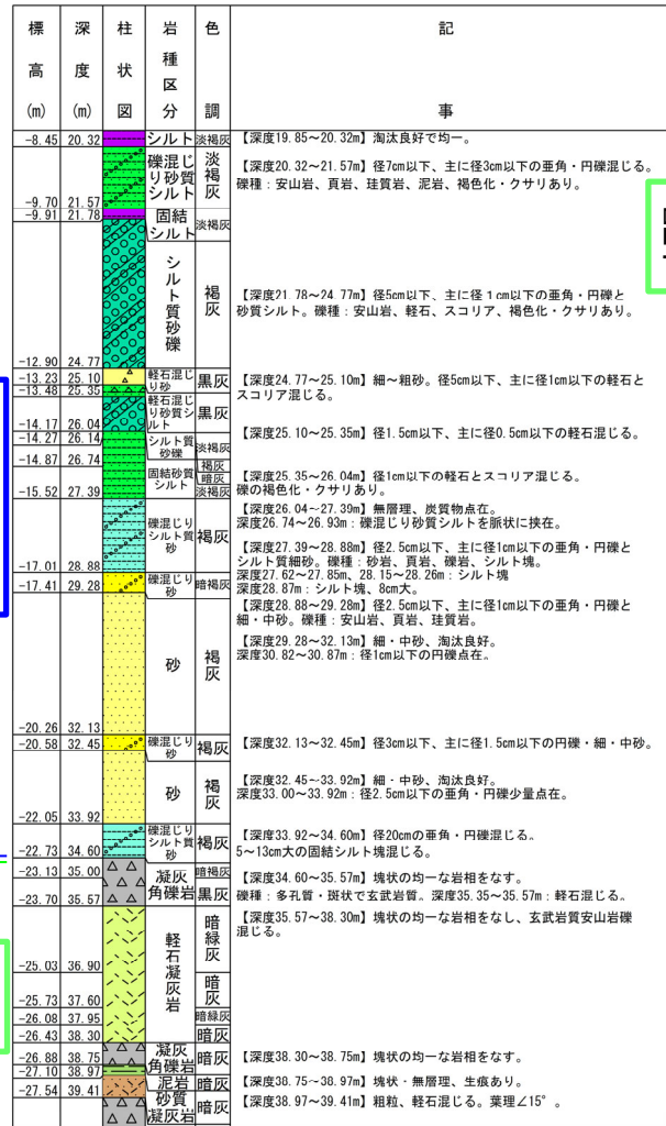
ボーリング柱状図 (深度20~40m)
