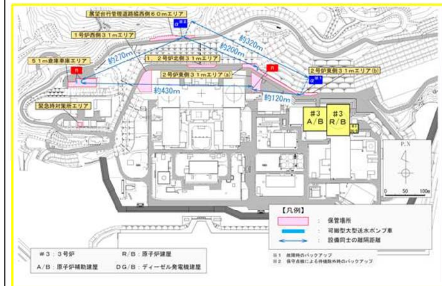
可搬型大型送水ポンプ車の相互の離隔距離
