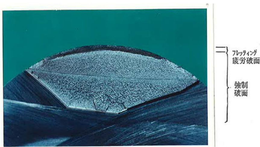
図7 フレット疲労破面例
