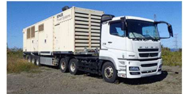
可搬型代替電源車
