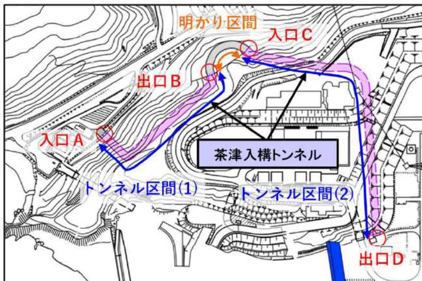
茶津入構トンネル 平面図 (令和4年7月28日審査会合資料(一部修正))
