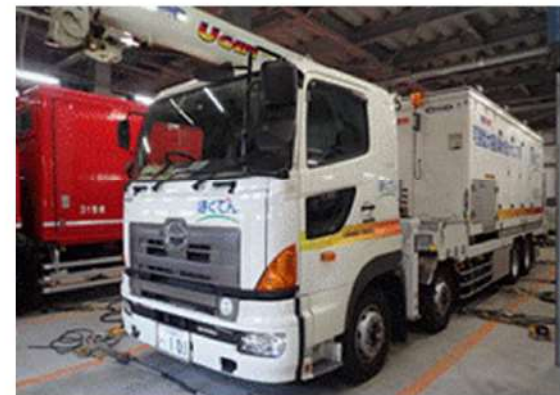
可搬型大容量海水送水ポンプ車
