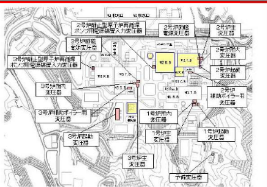
第 8-12 図 女川原子力発電所敷地内における変圧器の位置
