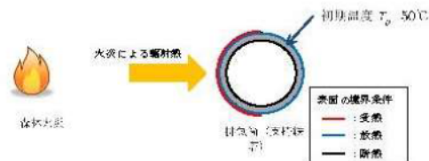
第3.4-4図 伝熱の境界条件の模式図
