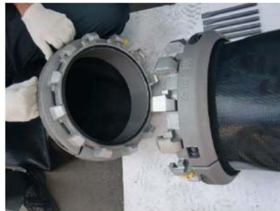
可搬型ホース(300A)接続口
