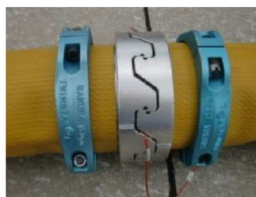
可搬型ホース(150A)接続後
