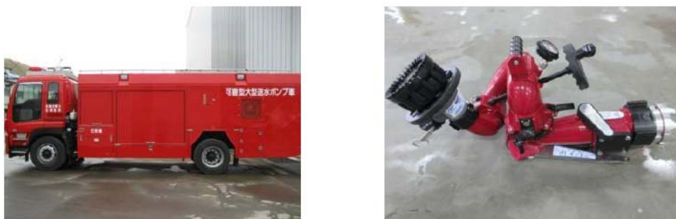
第3図 可搬型大型送水ポンプ車及び小型放水砲
