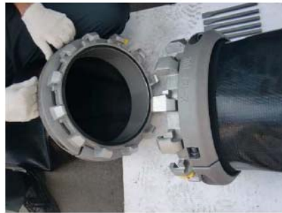
可搬型ホース(300A)接続口
