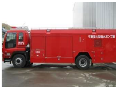
可搬型大型送水ポンプ車
