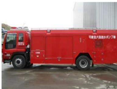
可搬型大型送水ポンプ車
