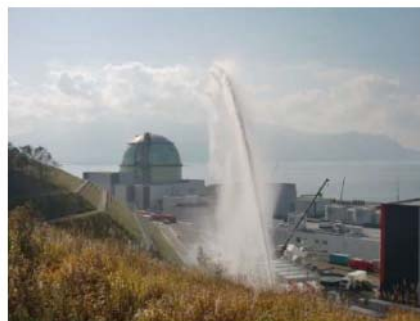
第2図 直状放射による放水状況
