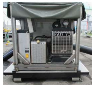
泡混合設備設置
