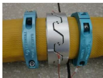
可搬型ホース(150A)接続後
