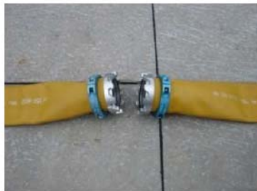
可搬型ホース (150A) 接続口
