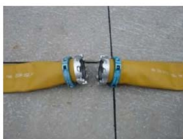
可搬型ホース (150A) 接続口
