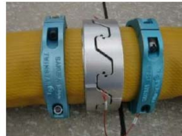
可搬型ホース (150A) 接続後
