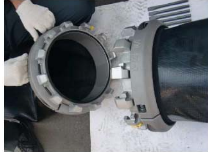
可搬型ホース(300A) 接続口
